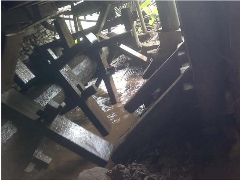
水碓是从主河中引一水渠，蓄积在一池塘中，从这一池塘引水，转动水轮，带动舂米。所以这一池塘在枯水期就可以用于其他水利用途，形成一个小型的水利调节设施。这种水利调节设施对周边社区的水资源进行调节，就可以形成一个松散的水利共同体。
