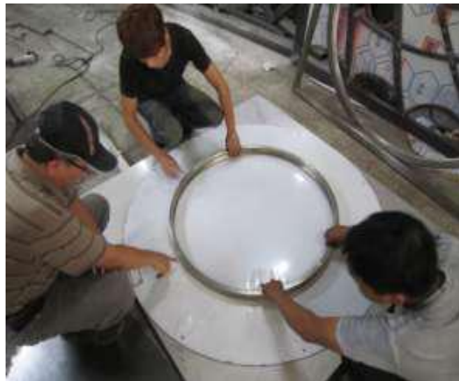
外牆主體物件底盤及外框製作過程
